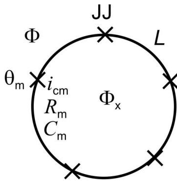
Рис. 6. Схема сверхпроводящего кольца с  $N$  джозефсоновскими контактами. Обозначения и числовые значения параметров – в тексте
