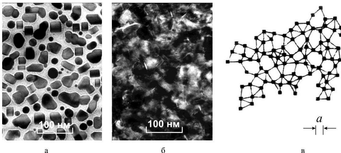
Рис. 1. Электронно-микроскопические (TEM) снимки гранулированной пленки ванадия (образец V-41): а – островковый подслой, б – готовая гранулированная пленка и в – модель случайных сверхпроводящих кластеров,  $a$  – средний размер гранул
