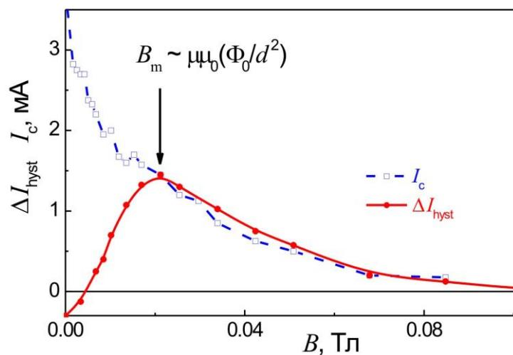
Рис. 4. Ширина петли АГ на ВАХ и критический ток образца V-68 в зависимости от магнитного поля;
