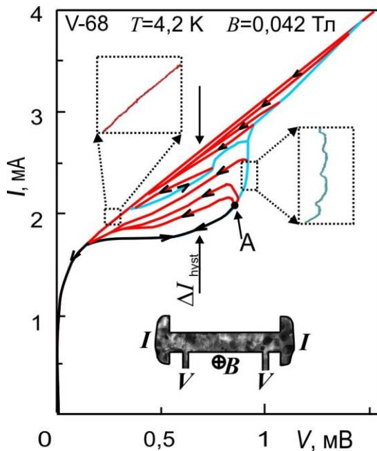
Рис. 5. АГ на ВАХ пленки ванадия (V-68) при записи в двух направлениях из различных точек ВАХ.  $T=4,2$  К,  $B=0,034$  Тл. Точкой А обозначена граница обратимости ВАХ. На вставке внизу – схема образца
