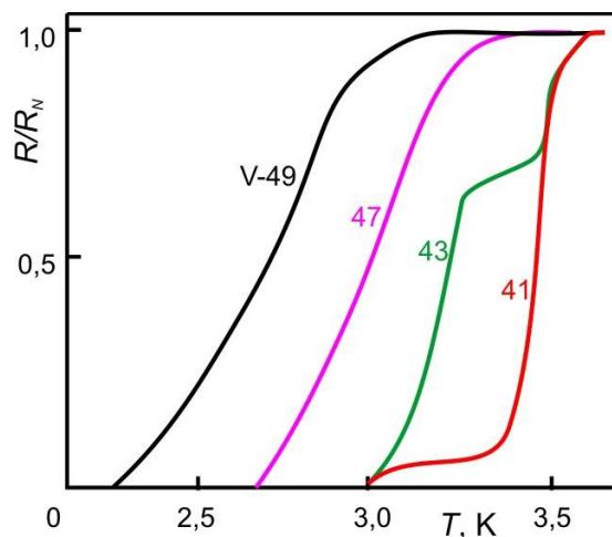
Рис. 2. Резистивный сверхпроводящий переход гранулированных пленок ванадия с различной степенью окисления границ зерен
