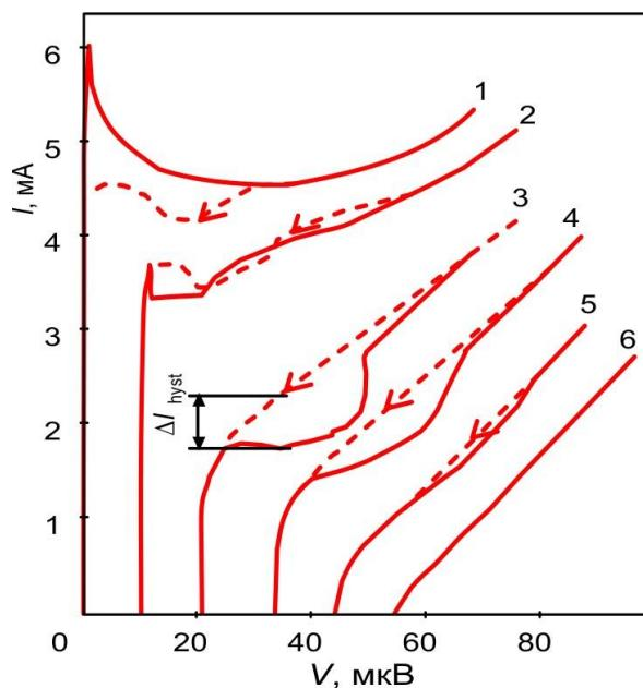
Рис. 3. Аномальный гистерезис на ВАХ образца V-68 в различных магнитных полях:
