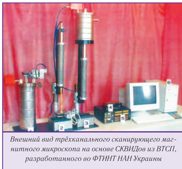
*Внешний вид трёхканального сканирующего магнитного микроскопа на основе СКВИДов из ВТСП, разработанного во ФТИНТ НАН Украины*
