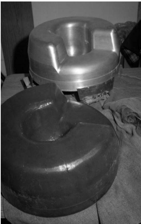
Рисунок 5 – Оснастка для изготовления профильных «Helmet-type» донных частей стеклопластикового криостата и готовая стеклопластиковая заготовка дна
