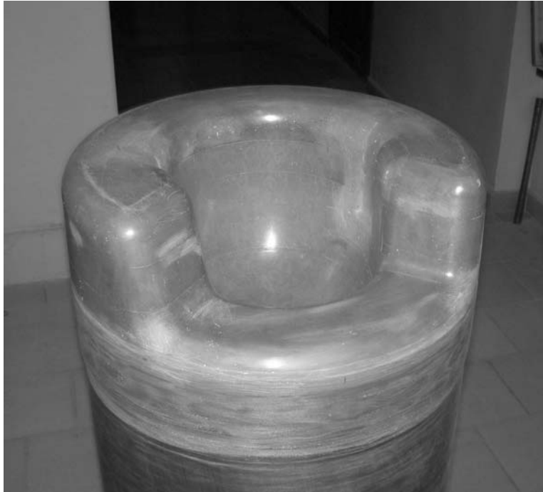
Рисунок 7 – Фотография внутренней цилиндрической емкости с вклеенным «Helmet-type» донной частью
