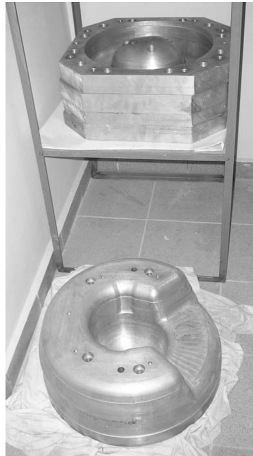
Рисунок 5 – Оснастка для изготовления профильных «Helmet-type» донных частей стеклопластикового криостата и готовая стеклопластиковая заготовка дна
