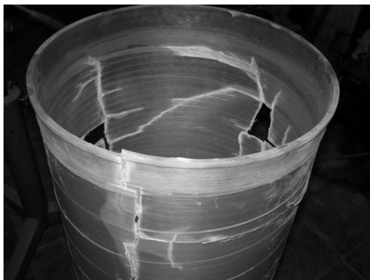
Рисунок 8 – Внутренняя стеклопластиковая оболочка МЭГ криостата после проведения испытаний на устойчивость при нагружении внешним давлением
