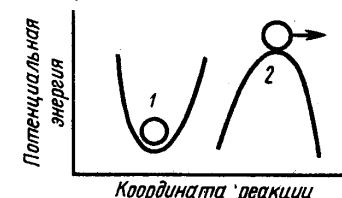
1 — молекула находится в устойчивом состоянии в потенциальной яме; 2 — активированный комплекс движется вдоль координаты реакции через вершину потенциального барьера
