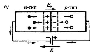
и его сопротивление возрастает – такое направление называется **запирающим (обратным)**. Если направление внешнего поля противоположно полю контактного слоя (б), то перемещение электронов и дырок приведет к сужению контактного слоя и его сопротивление уменьшится – такое направление называется **пропускным (прямым)**.
