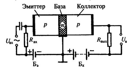
постоянное смещающее напряжение в прямом направлении, а между базой и коллектором – постоянное смещающее напряжение в обратном направлении. Усиливаемое переменное напряжение подается на входное сопротивление  $R_{вх}$ , а усиленное – снимается с выходного сопротивления  $R_{вых}$ .
